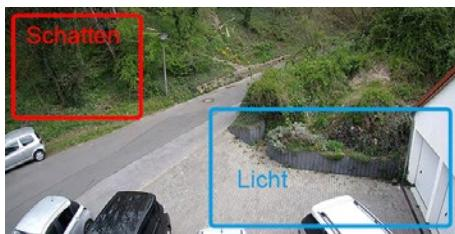
Details sowohl in dunklen als auch in hellen Bildbereichen kommen besser zur Geltung. Dadurch, dass die einzelnen Objektbereiche in einer Szene von der Kamera unterschiedlich belichtet werden, sind die Objekte in den hellen sowie in den dunklen Bereichen sichtbar.
